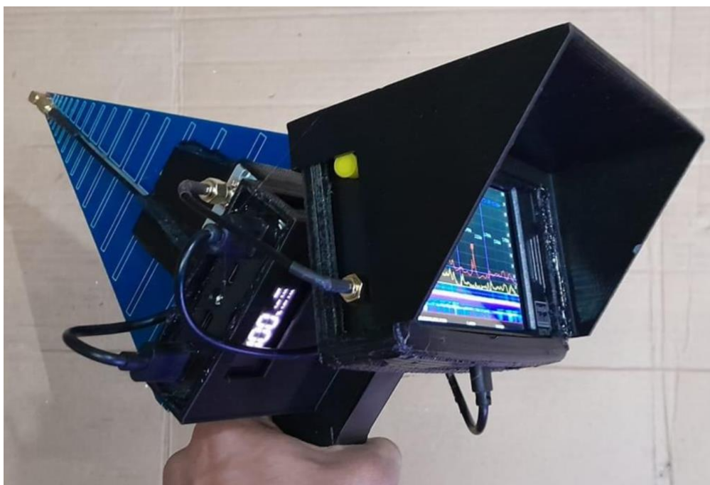
Рисунок Е.1. Варіант компоновки портативного пристрою радіотехнічної розвідки на базі аналізатора спектру “TINY SA ULTRA”
