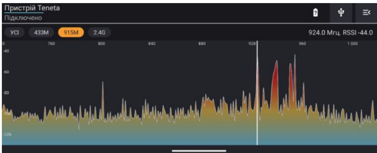
Рисунок Е.6. Вигляд при виявленні пакетів з пульта ELRS 915МГц
