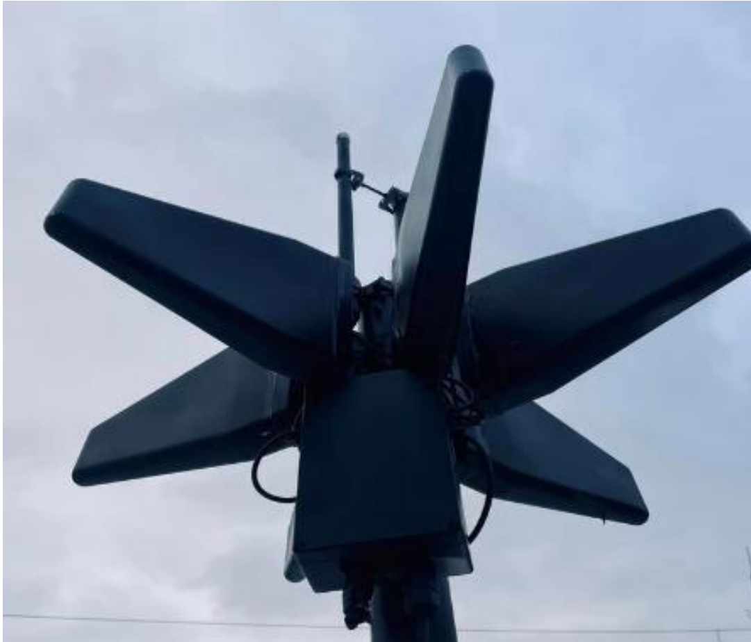
Рисунок.Е.2. Багатоелементна антенна система з комутацією антен.
