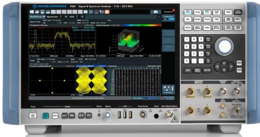
Рисунок 2.13. Аналізатор сигналів R&S FSW з відображенням векторної діаграми сузір'їв багатопозиційних сигналів
